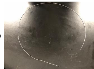
図 2. 実際に作製した YbBCO 丸線材
