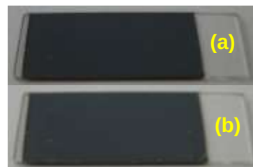
図3 5分間プラズマ照射前後の \text{Bi}_2\text{Te}_3 薄膜 (a) 照射前、(b) 照射後
