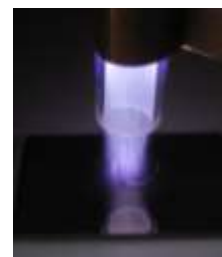
図2 \text{Bi}_2\text{Te}_3 薄膜へのプラズマジェット照射の様子
