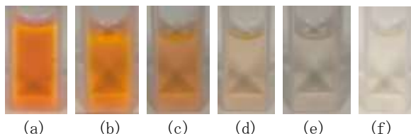
図 3 プラズマジェット照射に伴うローダミン 6G 水溶液の色の变化: (a)照射前、(b) 10 分間、(c) 20 分間、(d) 30 分間、(e) 40 分間、(f) 50 分間照射
