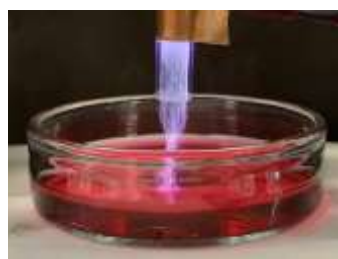
図 2 ニューフクシン水溶液へのプラズマジェット照射の様子
