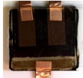
図2. 封止したペロブスカイト太陽電池
