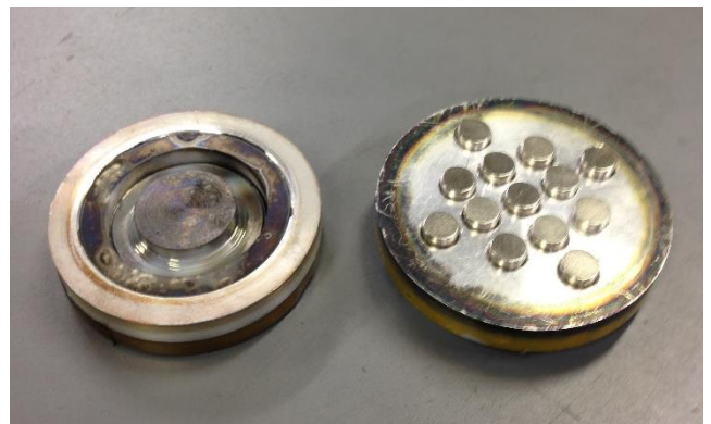
Fig. 1 リング型とクロス型(十字型)の磁石配置
