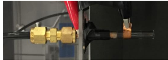
図 1. 現在使用している設置型の大気圧プラズマジェット発生装置
