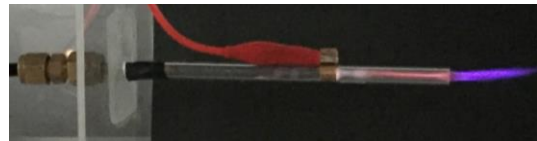
図 1. 現在使用している設置型の大気圧プラズマジェット発生装置
