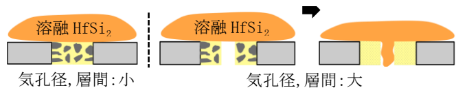
図 4 C/C 材の気孔径、層間による形成組織への影響
