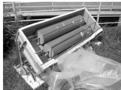
写真1：実験装置の実物（実際は表面は黒色塗装されている。またこの装置の上にビニールをかぶせている）
