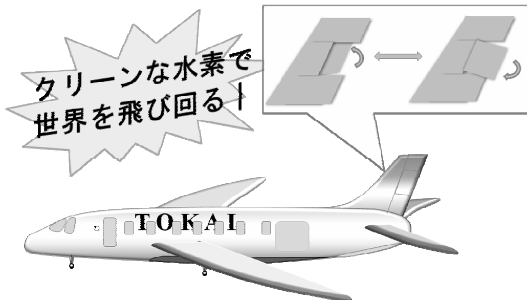
図 1 航空機用ラダーへの応用の概略図
