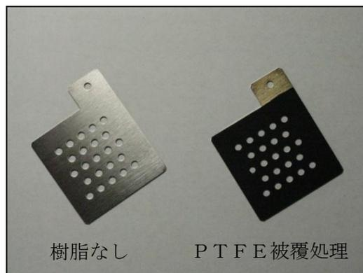
図1 P T F E 樹脂被覆セパレータ
