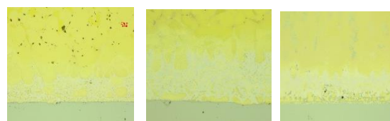
図2 ろう付部断面マイクロ組織 C3604 (左) C4621 (中央) C6931 (右) 上部が黄銅、下部がステンレス鋼
