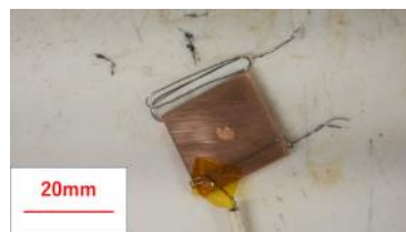
図1 はんだ付温度240℃の試験片のフラックス溶融開始時の状態
