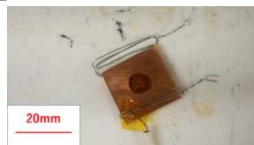
図2 はんだ付温度240℃の試験片のフラックスのぬれ広がりが完了したときの状態
